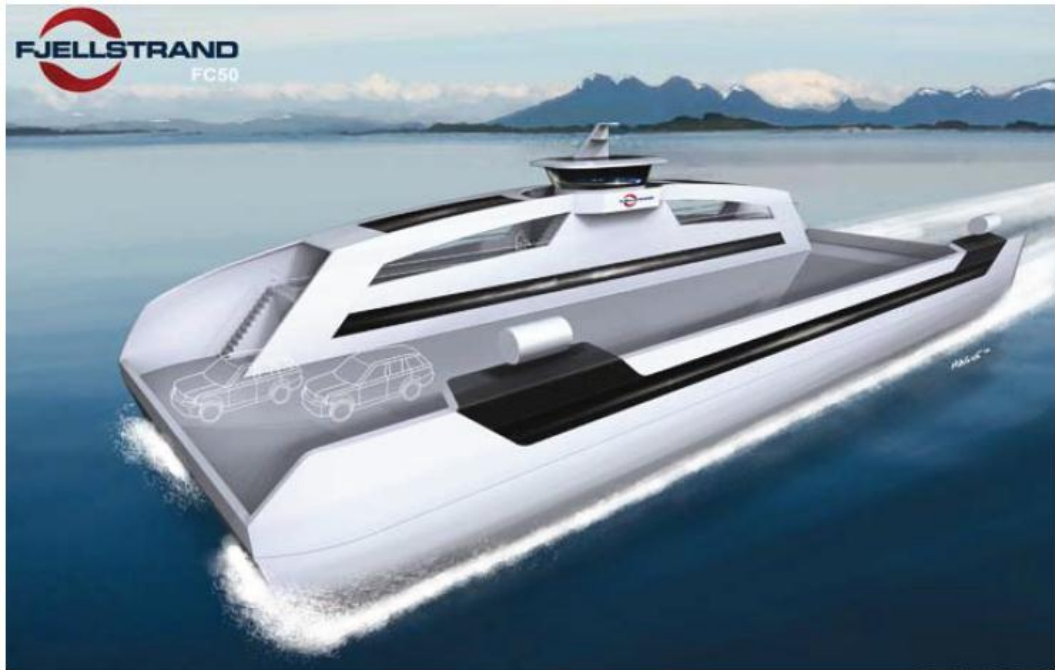
Figur 3: Fjellstrand AS - Ferje med framdriftssystem på batteri (illustrasjon Fjellstrand AS)
