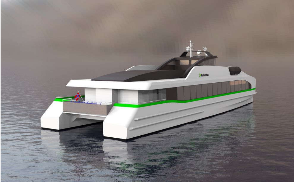
Figur 27: Fjellstrand verft i Omastrand bygger batteridrevne hurtigbåtar med nullutslepp.
