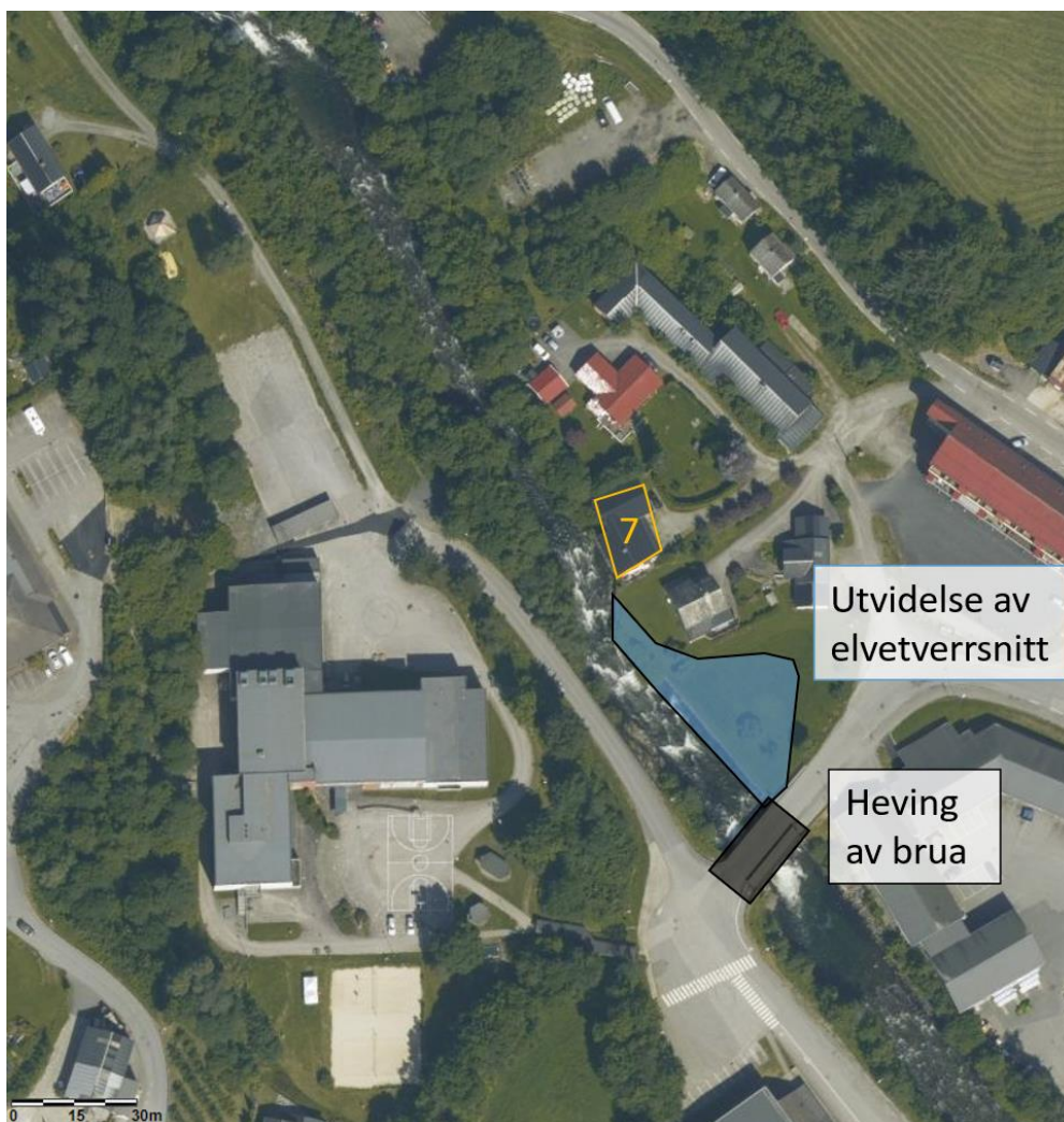
Figur 2-21. Heving av Holmane bru og utvidelse av elveløpet.
