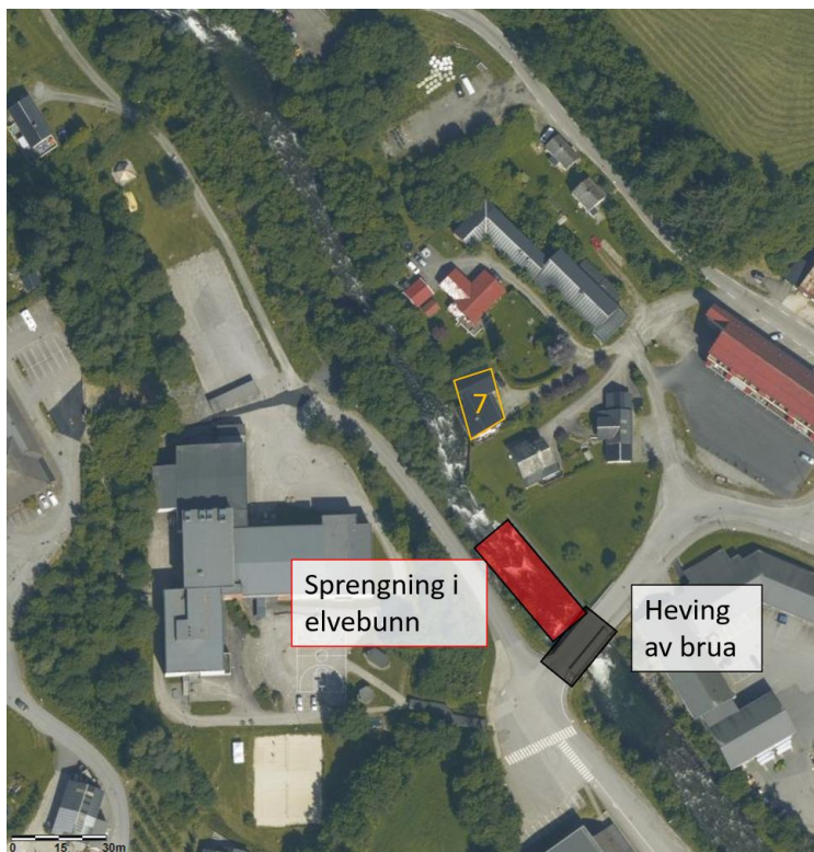
Figur 2-19. Heving av Holmane bru og sprengning i elveløpet.
