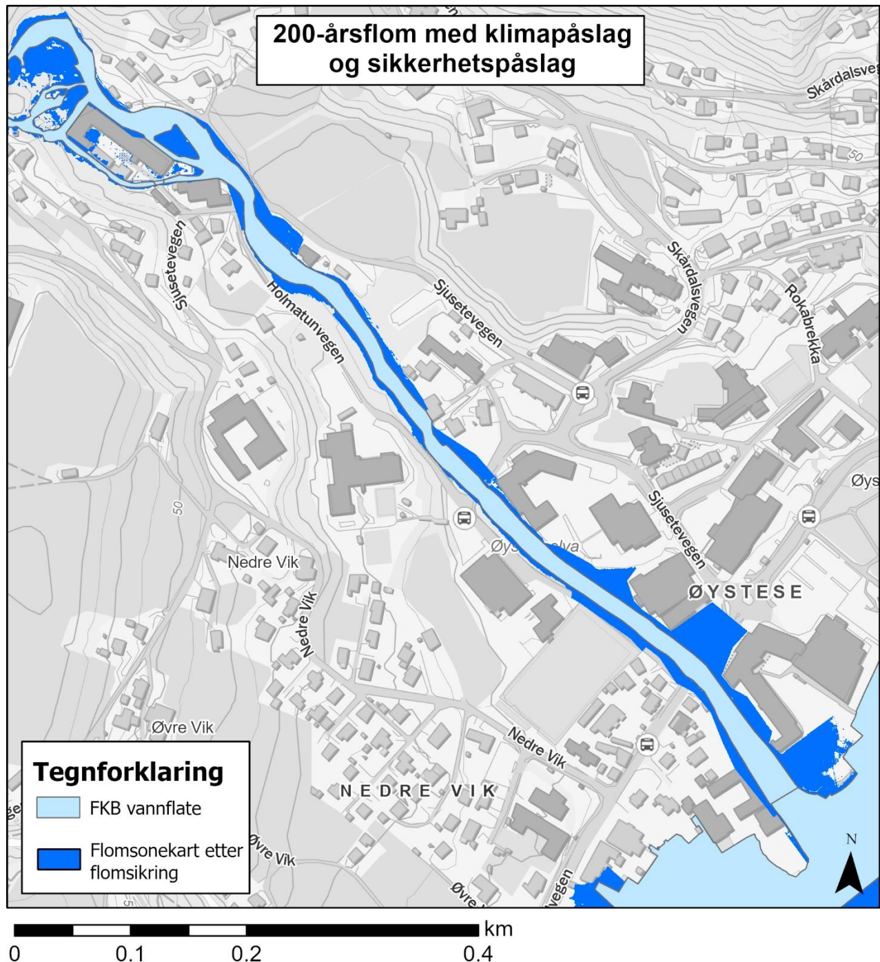
Figur 3-2. 200-årsflom, simulering av anbefalte tiltak ved alle delområder (samlet resultat), uten tiltak på Hardangerfjordbrua.
