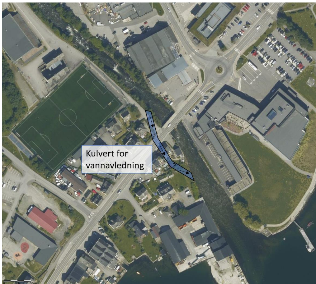
Figur 2-29. Etablering av en kulvert for vannavledning forbi Hardangerfjordbrua
