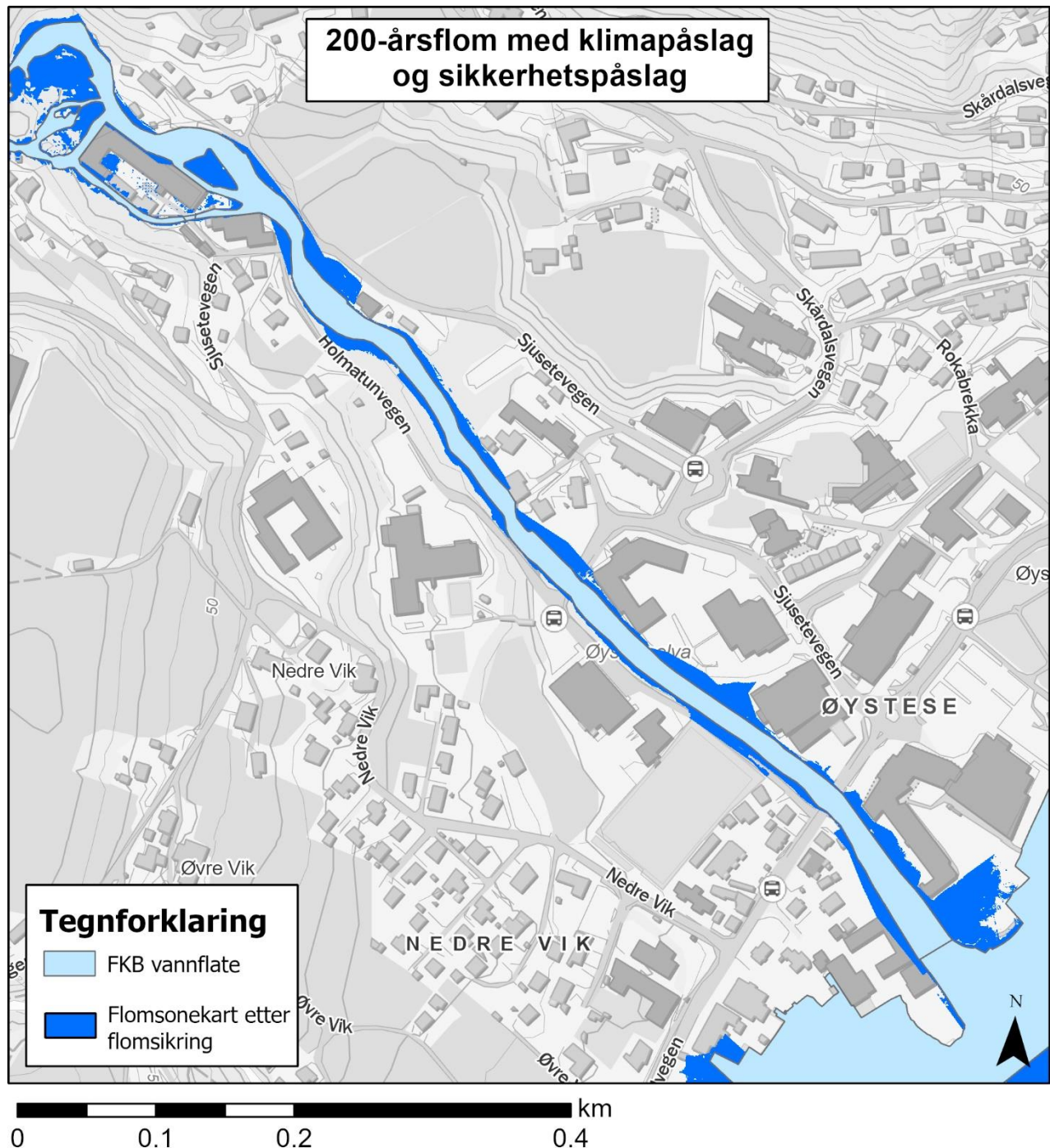
Figur 3-3. 200-årsflom, simulering av anbefalte tiltak ved alle delområder (samlet resultat), med heving av Hardangerfjordbru.
