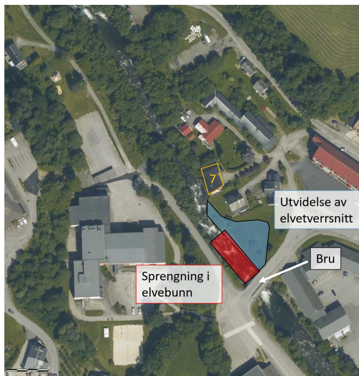
Figur 2-17. Sprengning i elveløpet og utvidelse av elveløpet ved Holmane bru
