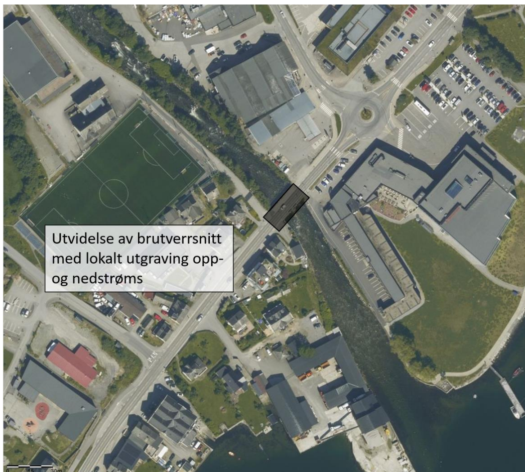
Figur 2-37. Utvidelse av brutverrsnittet ved Hardangerfjordbrua.
