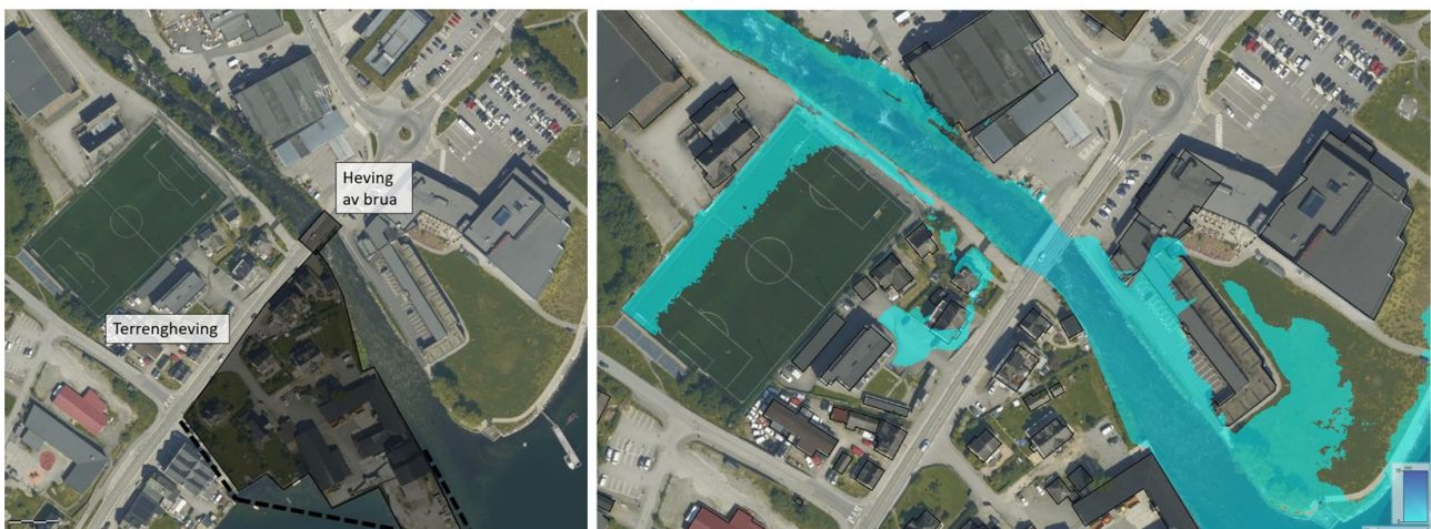
Figur 2-41. Til venstre: Terrenghaving sørvest for Hardangerfjordbrua og heving av brua. Stiplede linjer viser hvor grensen til terrenghaving ikke er fastsatt. Til høyre: Flomsonekart etter tiltak.
