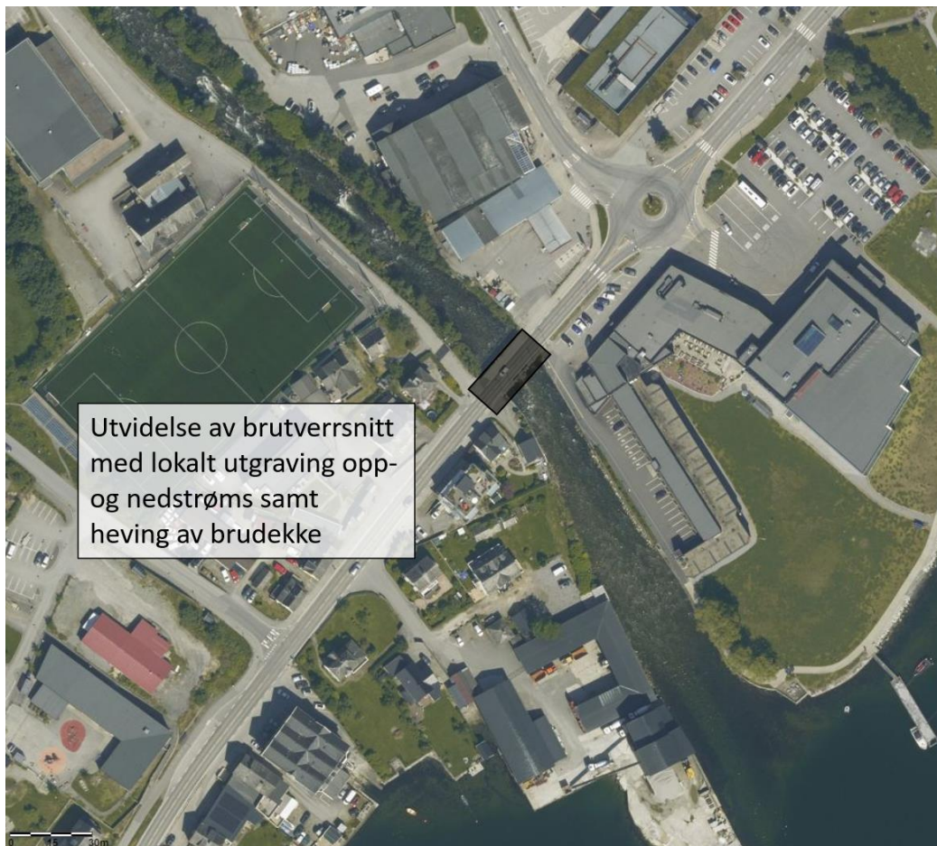
Figur 2-38. Utvidelse av brutverrsnittet og heving av brudekke ved Hardangerfjordbrua.
