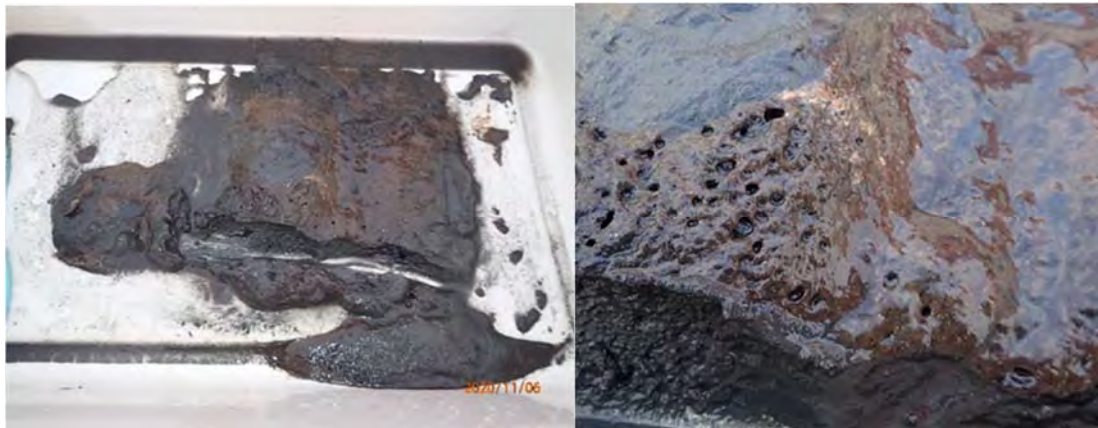
Prøve ikkje silt, pga. lukt av hydrogen sulfid.
