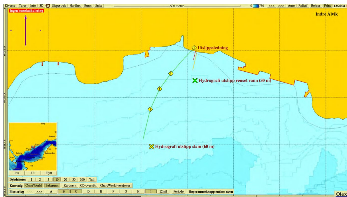
Figur 2.1.5. Hydrografimålinger ble utført utenfor utslippet for slam på 59 meters dyp (gult kryss) og utenfor utslippet for renset vann på 30 meters dyp (grønt kryss).
